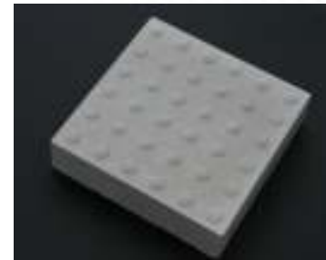
Noppenplatte aus Faserbeton (36 Noppen)
