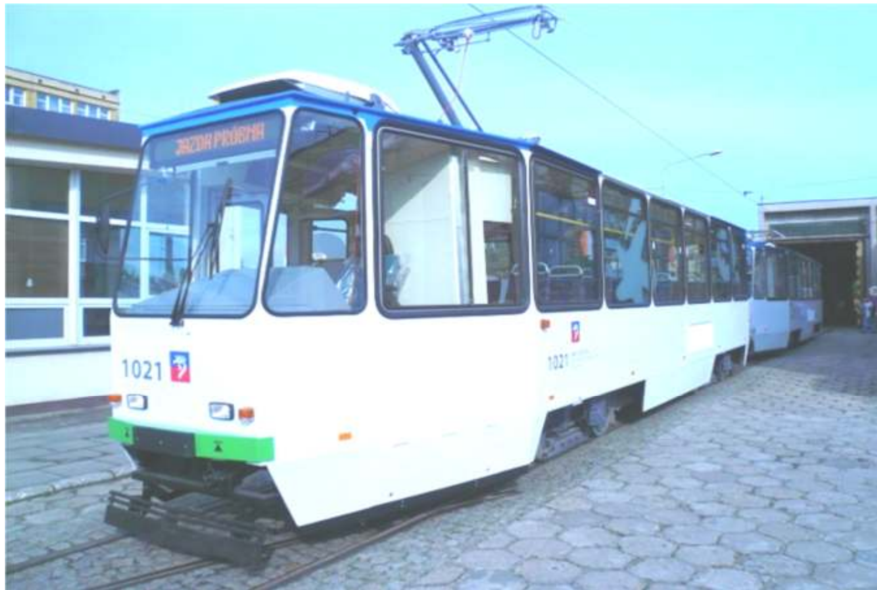
Wagon 105Na po modernizacji
