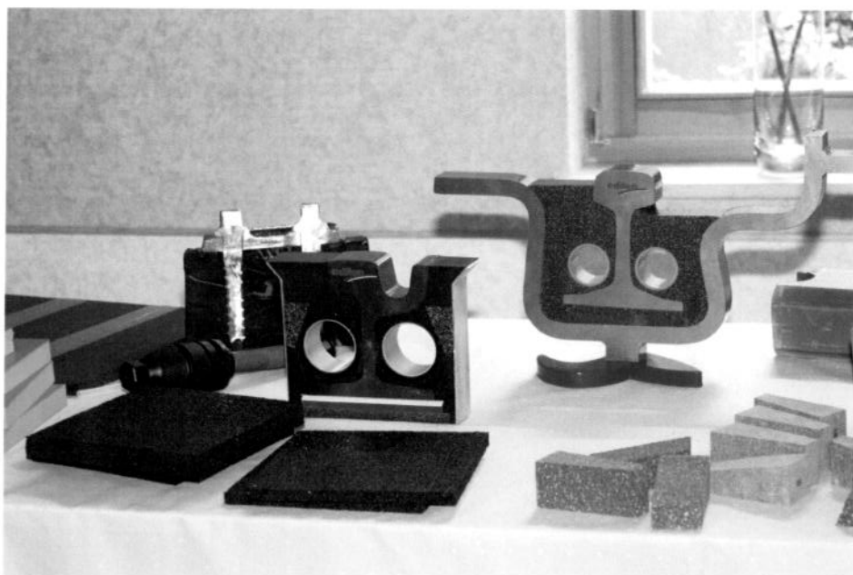
Rys. 13 Przykładowe rozwiązania systemu zabudowy szyny w otulinie
